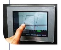
Développée par les ingénieurs Matrelec, la WAA Technology® permet l'auto ajustement de la puissance et la mémorisation des soudures sous forme de courbes indispensables au process de traçabilité et à la répétabilité.
